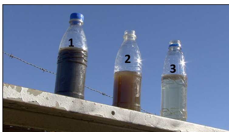
Figura 02: Aspecto visual das amostras do efluente em diferentes fases do tratamento: 1- saída do biodigestor; 2- saída da lagoa de armazenamento; 3- saída da lagoa de lemnas (reservatório para reuso).
